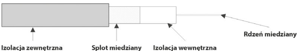
Rysunek 3.1. Budowa kabla koncentrycznego
