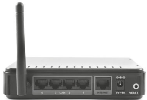
Rysunek 5.10. Router WiFi – panel tylny. Widoczne elementy (od lewej): antena WiFi, 4 porty LAN, Port WAN, wejście zasilania, przycisk RESET
