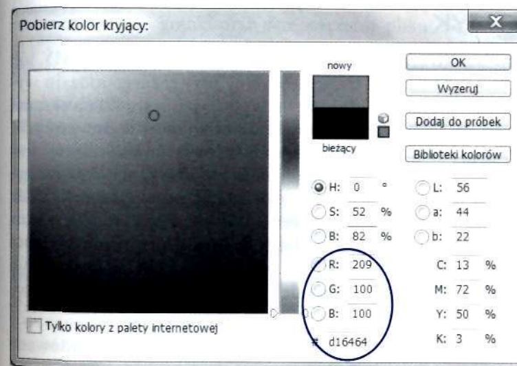
Rysunek 5.9. Próbnik kolorów. Możliwość wybrania składowych koloru poprzez podanie wartości R, G, B lub kodu heksadecymalnego
