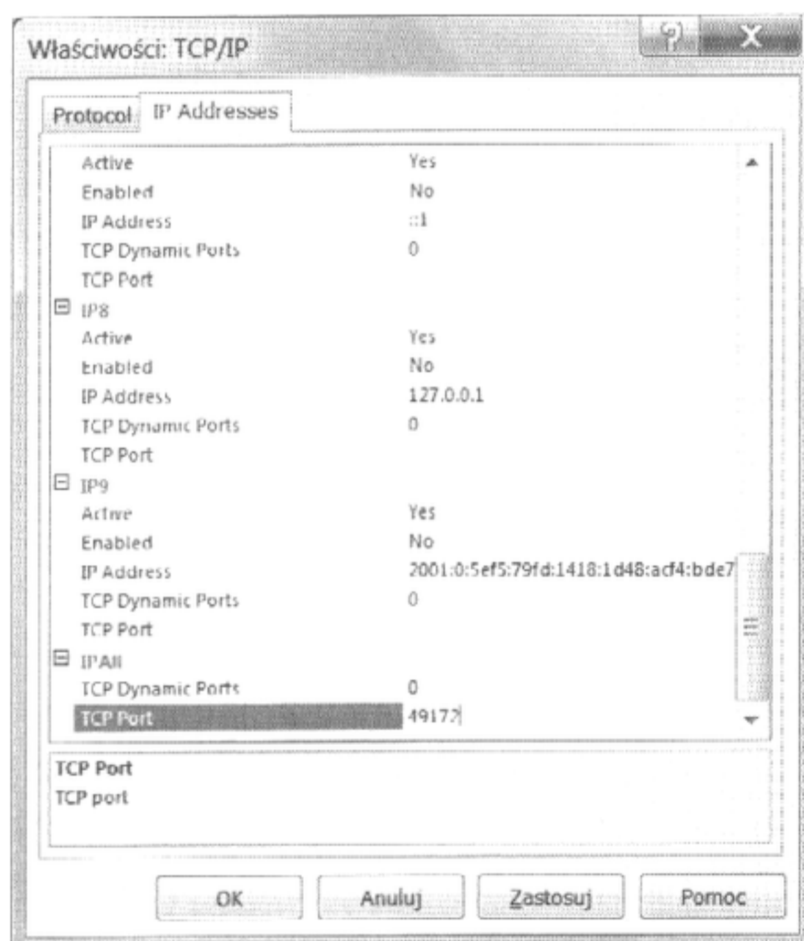
Rysunek 6.34. Konfigurowanie serwera do nasłuchiwanie na określonym porcie
